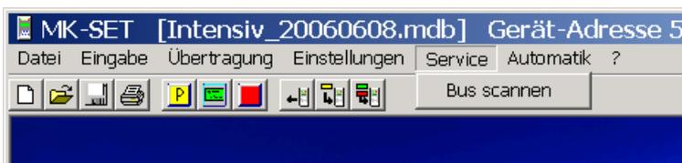
Die Funktion "Bus scannen" dient dazu, das gesamte MEDICS-Netzwerk abzutasten (scannen). Alle gefundenen Geräte mit ihren Geräteadressen und Versionsnummern werden dargestellt. Mit einem solchen Überblick ist es einfach, die Programmierung vorzunehmen. Zudem ist es mit dieser Funktion möglich zu prüfen, ob alle Geräte korrekt angeschlossen und ihre Bus-Adressen korrekt eingestellt sind.
